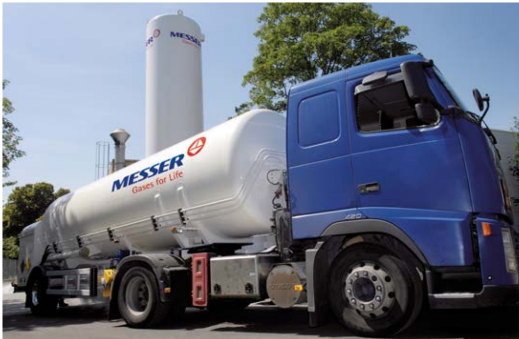
Bei Kunden mit größerem Gasebedarf stellt Messer stationäre Tanks auf, die über Tankfahrzeuge beliefert werden.
