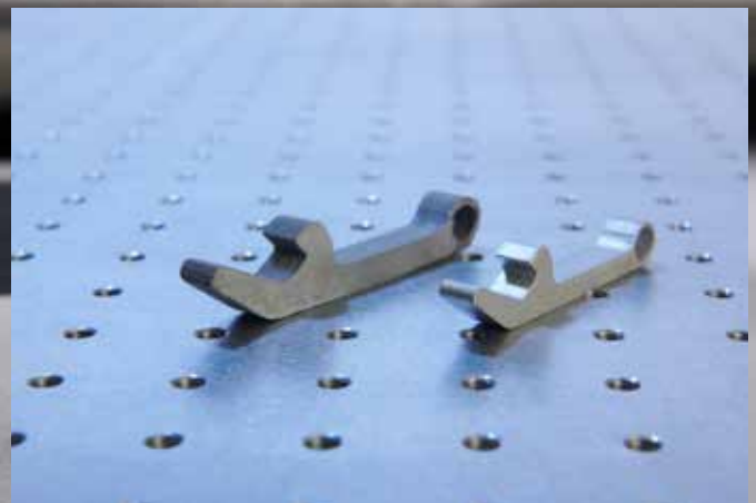
Binder Jetting (links: Grünling, rechts: fertiges Bauteil)
