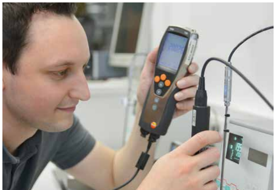
Kalibrierung im Messlabor von Testo
