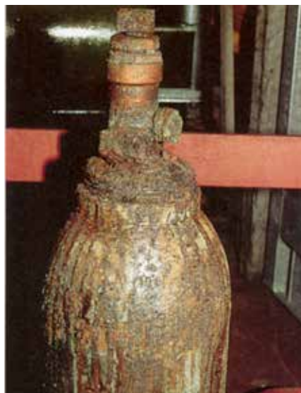
Flasche mit stark beschädigtem Ventil
