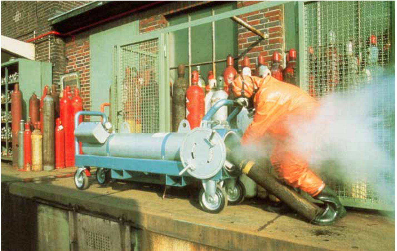
Hilfe bei Gasnotfällen: Abtransport defekter Stahlflaschen mit einem Bergungsbehälter
