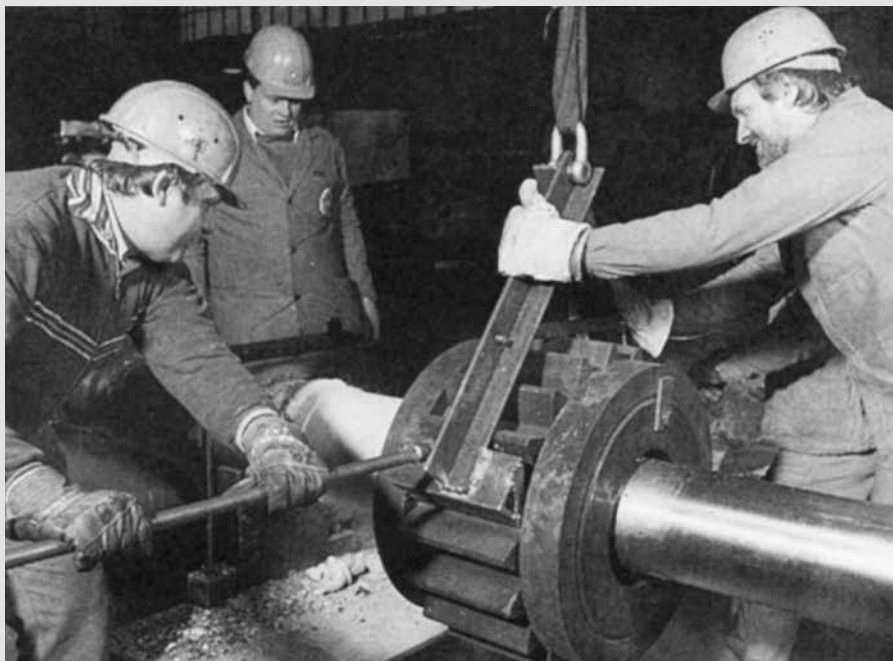
Montage: Das auf Maß gearbeitete Zahnrad wird zu dem gekühlten Anschlußteil geführt und aufgeschoben. Nachdem sich das Teil erwärmt und ausgedehnt hat, entsteht ein Preßsitz.
