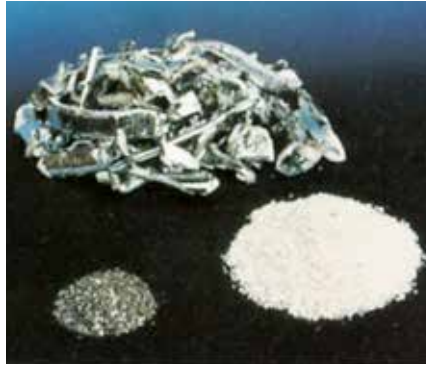
Verbundstoffe lassen sich durch Stickstoffkälte problemlos trennen und anschließend feinmahlen.
