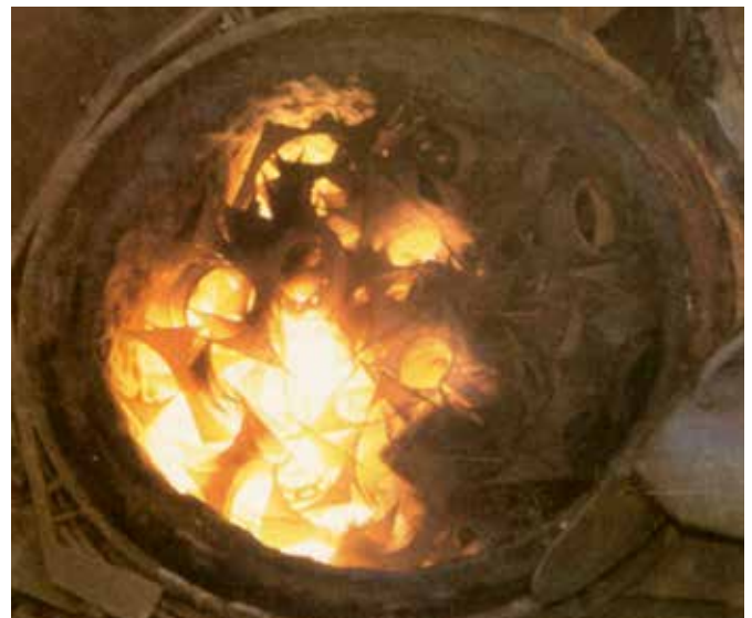
Einwirkung der Flamme auf den Schrott
