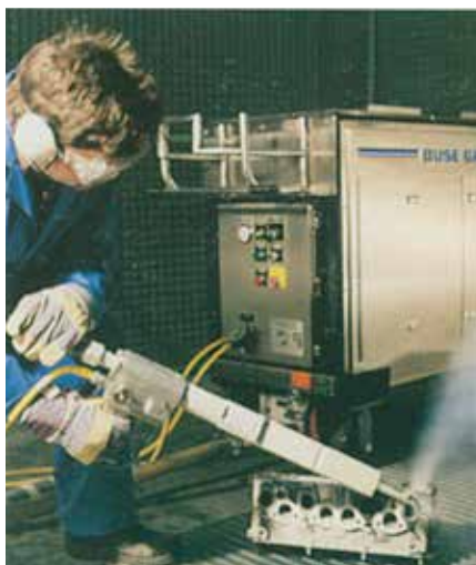
Auch da, wo es eng wird, kann jetzt mit der mobilen Einheit Cold Jet Junior schonend und umweltfreundlich gereinigt werden.
