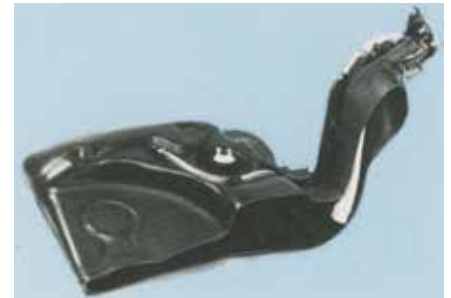
Kompliziert geformte Kraftstoffbehälter, wie z. B. beim VW Golf, stellen besonders hohe Anforderungen an die Sperrwirkung der fluorierten Grenzschicht
