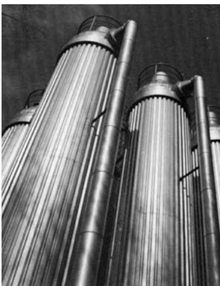
In diesen Bioreaktoren wird das Trinkwasser mit Hilfe von Wasserstoff von Nitrat befreit.
